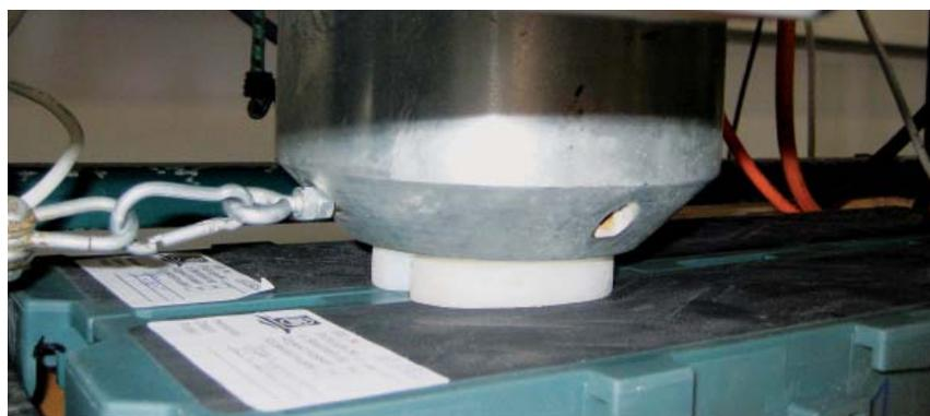
Bild 2: Messung der Rutschfestigkeit auf dem Spalt zwischen den Rosten (trocken)
